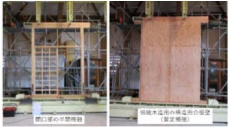
無かった構面に対して門型に壁を設けて補強をしています。トオリニワ<sup>\*20</sup>の中央にハシゴを横にしたような材を組み込んで木材のめり込みにより抵抗するような補強システムを採用しました。
